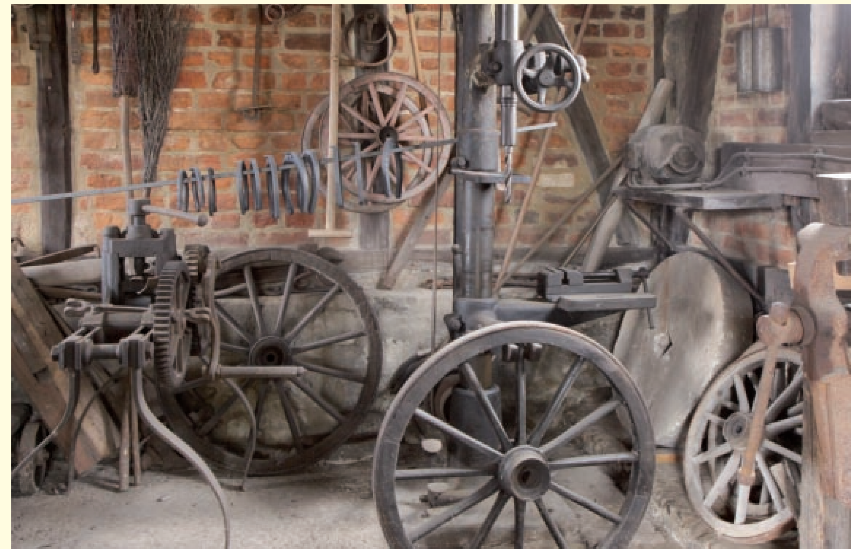
In der Bildmitte ist ein Bohrständler mit Transmission aus der Zeit um 1920 zu sehen, links daneben ein Reifenbiegeapparat von ca. 1890.
