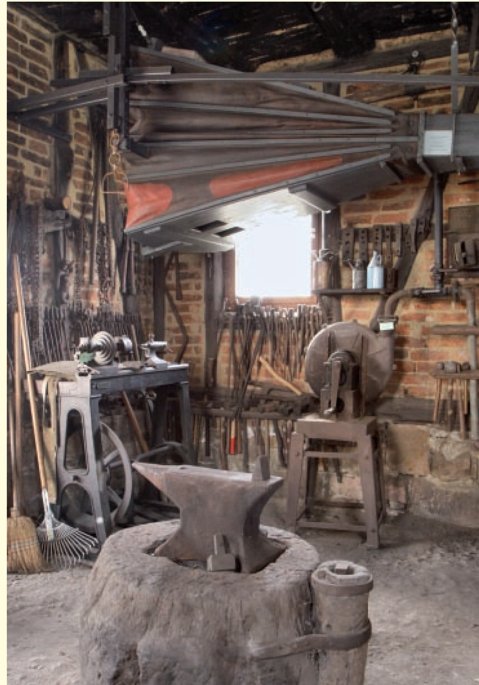
Blick in den Innenraum der historischen Schmiede. An der Wand (rechte Bildhälfte) steht ein Handgebläse von 1890, darüber hängt ein Blasebalg.
