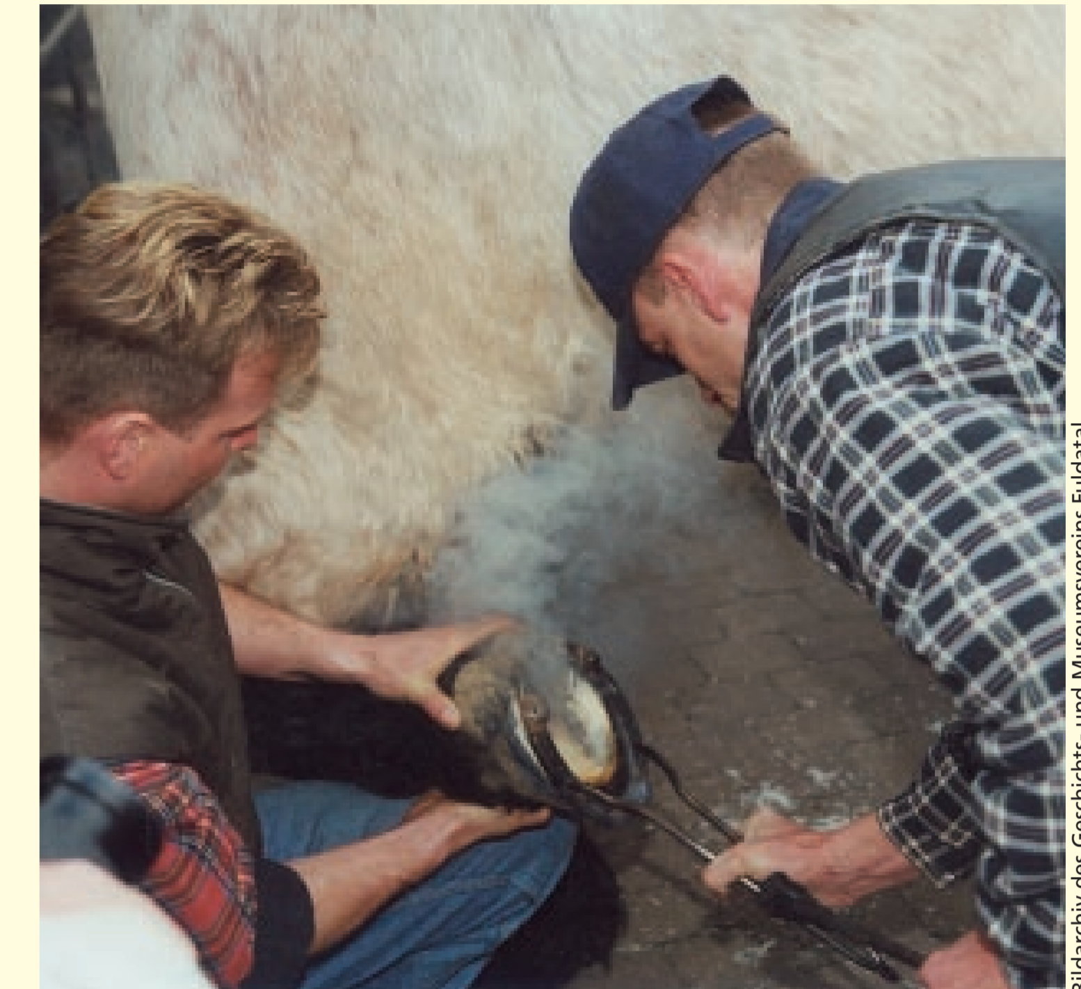
Die historische Schmiede wird zu Vorführungen des Arbeitskreises Heimatmuseum genutzt. Hier beispielsweise wird das Anpassen eines Hufeisens demonstriert.
