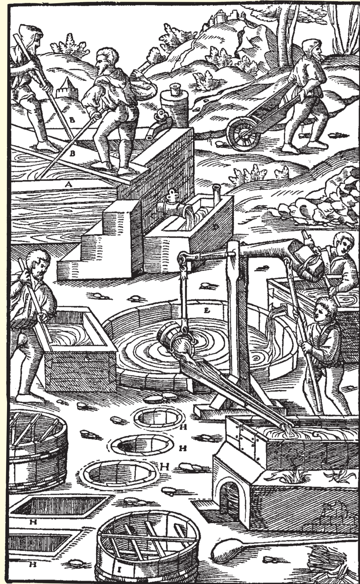
Das Bild aus dem Jahr 1556 zeigt die Arbeit im Alaun-Bergwerk: Den geförderten Alaun-Ton ließ man ein Jahr lang rösten und verwittern. Danach wurde er mit Wasser ausgelaugt. Um die Alaun-Kristalle zu erhalten, wurde die Lauge mit verfaultem Urin weiter behandelt. Die Arbeit in der Hütte war hart und ungesund: Dämpfe und schweflige Säure reizten die Atemwege. Die Bergleute waren zur damaligen Zeit ungefähr 12 Stunden im Werk.
