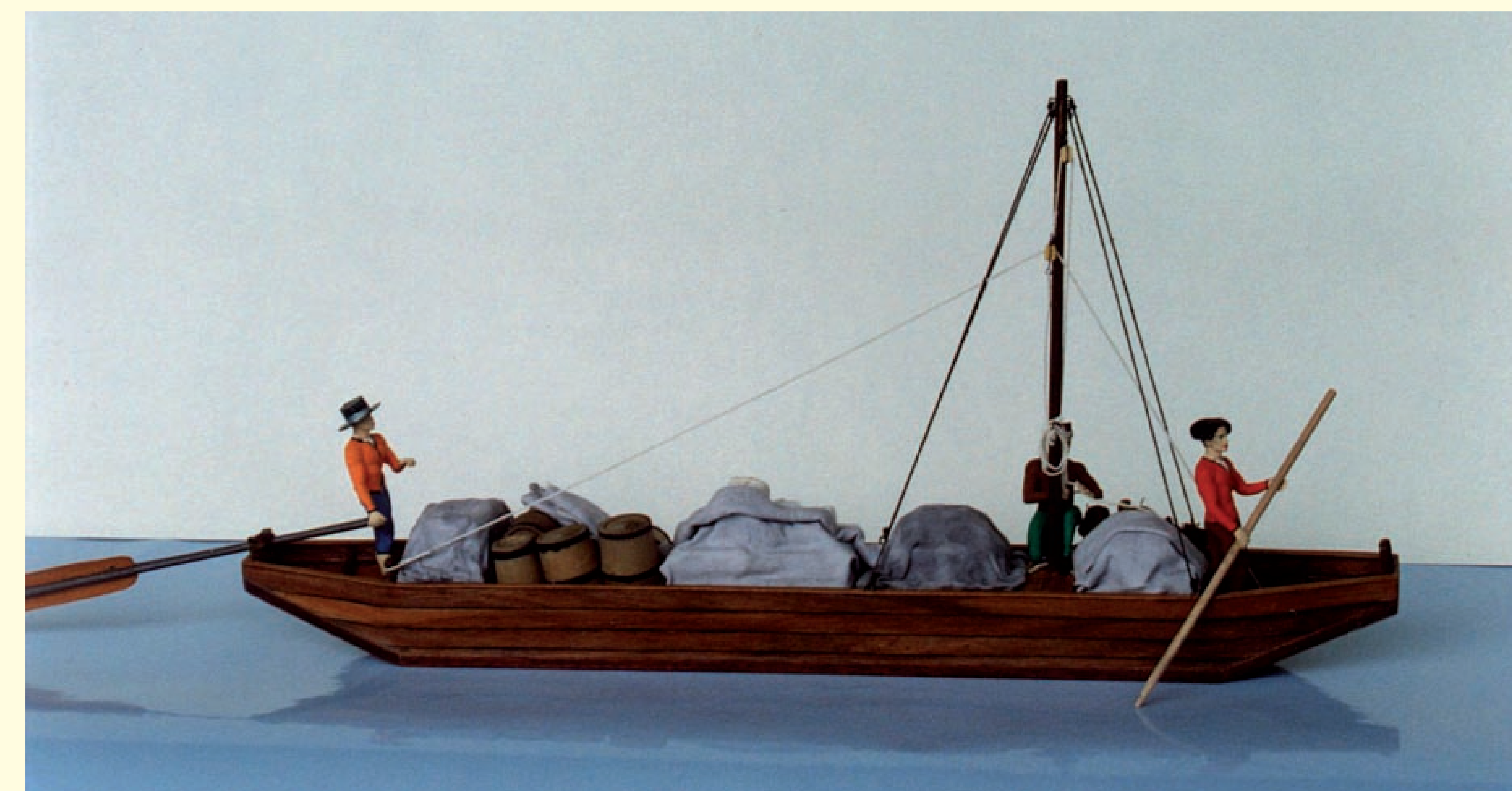
Über die Diemelschiffe sind keine Pläne vorhanden. In der Handschrift von Münnich geben die Skizzen eine Anschauung über Form und Größe dieser Schiffe. Für das Diemelschiff werden etwa diese Maße angenommen: Länge 10 m bis 12 m, Bodenbreite 1,2 m, Bordkantenbreite 1,50 m, Bordwand 0,8 m, Tiefgang je nach Wasser- verhältnissen bis 0,6 m, Tragfähigkeit ebenfalls je nach Wasserstand bis 6,0 t. Das Modell des Diemelschiffes im Maßstab 1:25 von Karl-Heinz Müller, Kassel, gebaut (1999).
