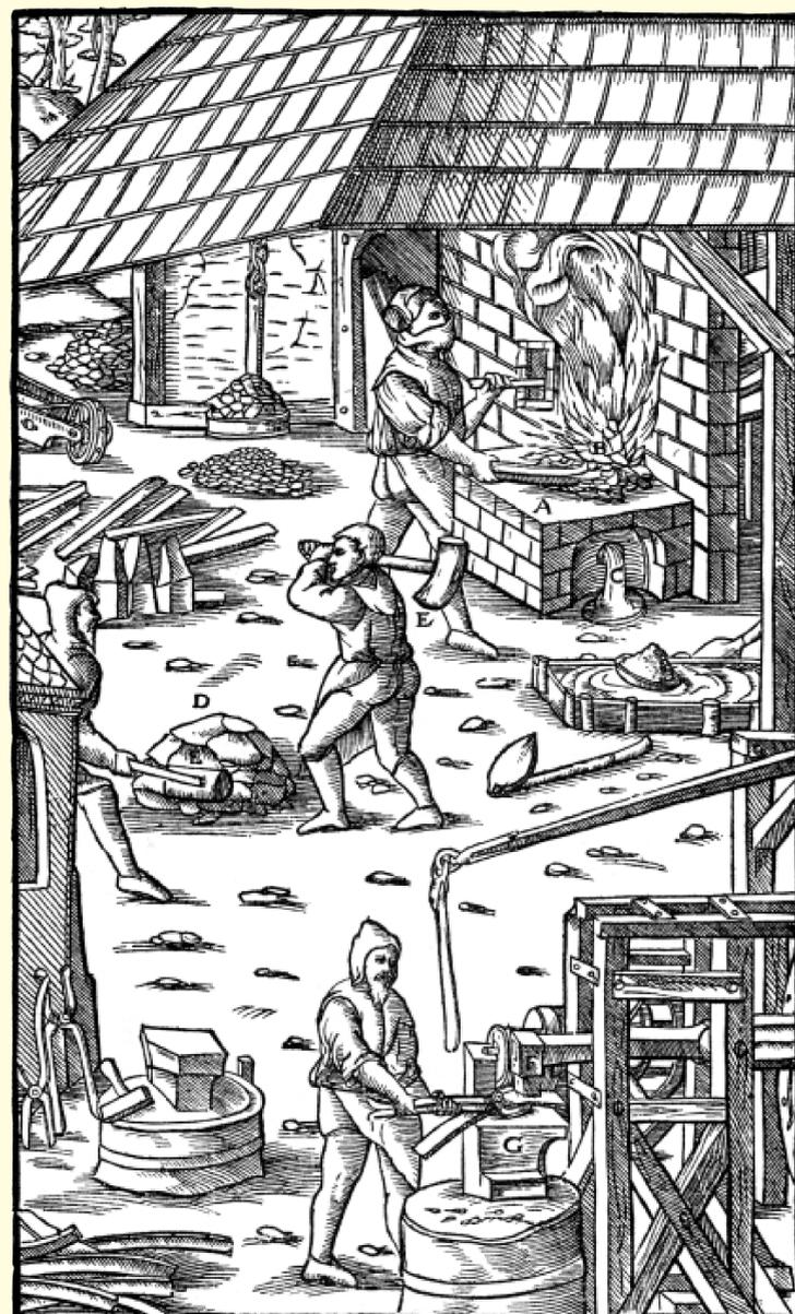
Darstellung der Eisenverhüttung in der Mitte des 16. Jahrhunderts: Oben schmilzt ein Arbeiter das Erz zu Eisen, das flüssige Metall läuft an der Seite heraus. In der Bildmitte schlagen zwei Helfer die Eisenluppe mit Holzhämmern, um die Schlacke zu entfernen. Unten formt ein Schmied das Roheisen zu Barren (unten links).
