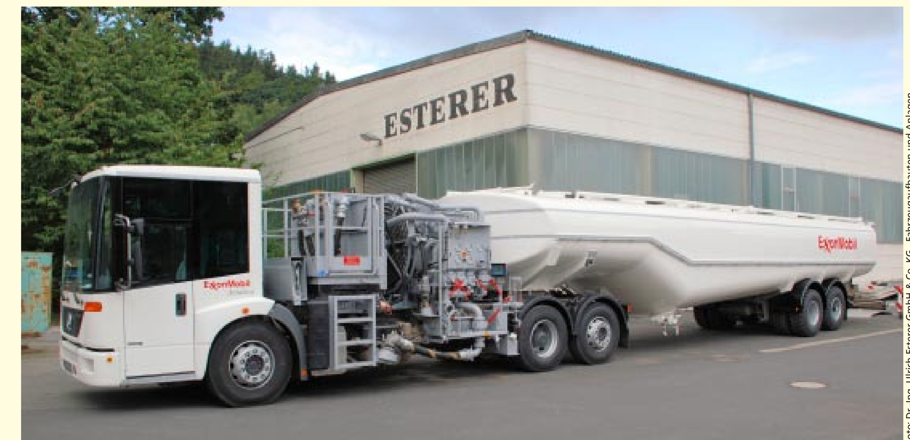
Modernes Fahrzeug für die Flugfeldbetankung.
